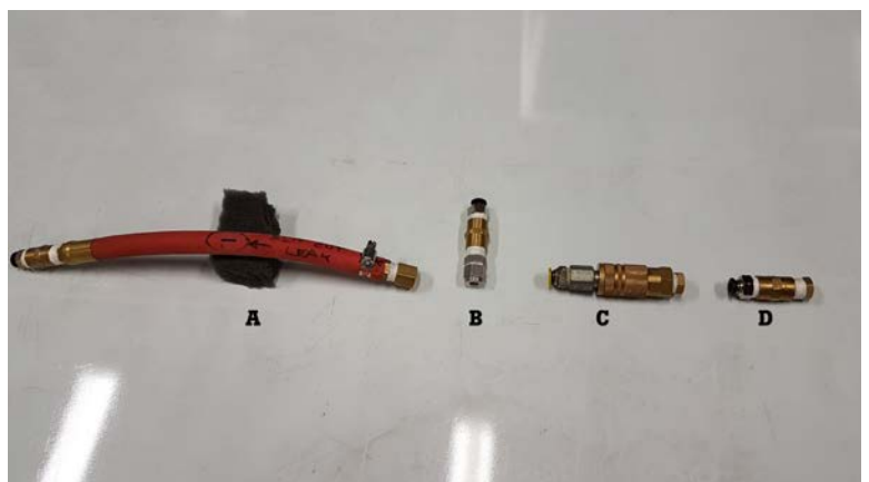
Рис. 5. Четыре типа утечек, которые были исследованы во время экспериментов: шланг (а), открытый конец (b), быстроразъемное соединение (c) и резьбовое соединение (d).
