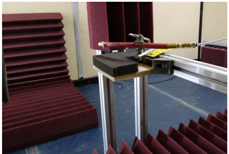
Рис. 3. Измерение утечки в шланге под углом 30 градусов.
