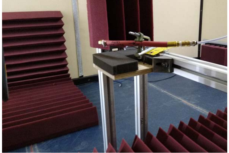
Şekil 3: 30 derece açıyla hortum sızıntı tipi ölçümü.
